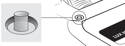
5. Interrupteur de réinitialisation - Situé sur le dessus du boîtier de l'aspirateur. Si le rouleau-brosse est coincé par des débris, son moteur s'arrête automatiquement. Débrancher simplement l'appareil et éliminer le blocage. Rebrancher l'aspirateur à la prise de courant et allumer l'appareil. Appuyer sur l'interrupteur de réinitialisation ROUGE sur le dessus de l'aspirateur; le moteur du rouleau de brosse redémarre.
